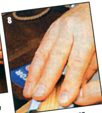
8 Ребра обрабатывают мелкозернистой шлифовальной шкуркой.
