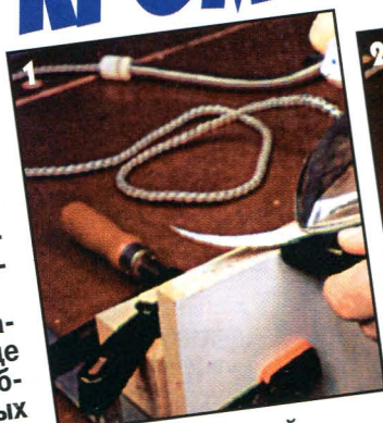
1 Размягченный клей и поврежденную облицовку удаляют лезвием ножа.
