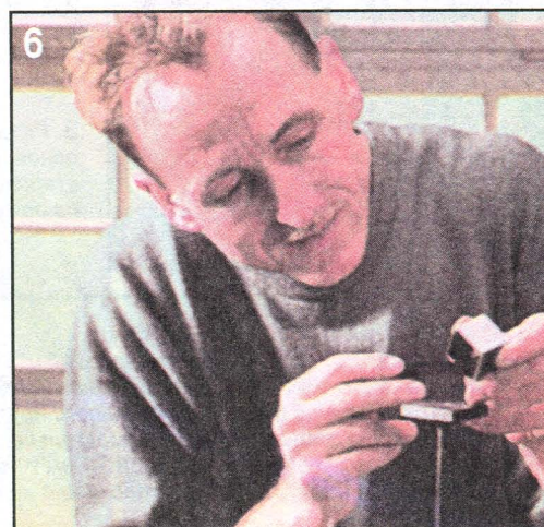
6. Шпателем наносим на соединяемые детали двухкомпонентный клей, соединение будет неразъемным.
