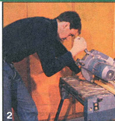
2 Рейки раскраиваем по длине с помощью торцовочной пилы. Длина их должна быть на 1 мм короче боковых стенок.
