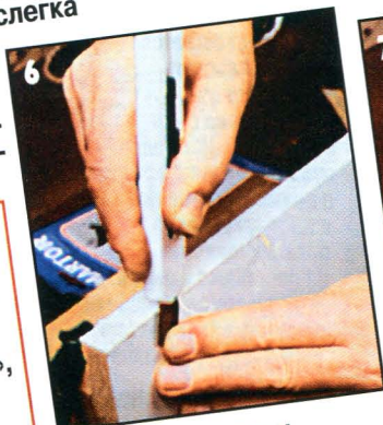
6 Продольные свесы срезают резаком, прижимая лезвие к поверхности полки.
