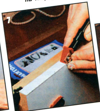
7 Специальный инструмент для обрезки свесов со сменным, заточенным с одной стороны лезвием.
